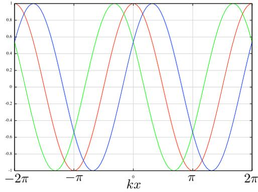
Figure 2: 波の伝播。赤線は  $\cos(kx)$ , 青線は  $\cos(kx - \delta)$ , 緑線は  $\cos(kx + \delta)$  である。2つの山の間隔から  $k\lambda = 2\pi$  がわかる。ある時間後に  $+x$  方向に伝播する場合は  $\cos(kx - \delta)$ ,  $-x$  方向に伝播する場合は,  $\cos(kx + \delta)$  となる。
