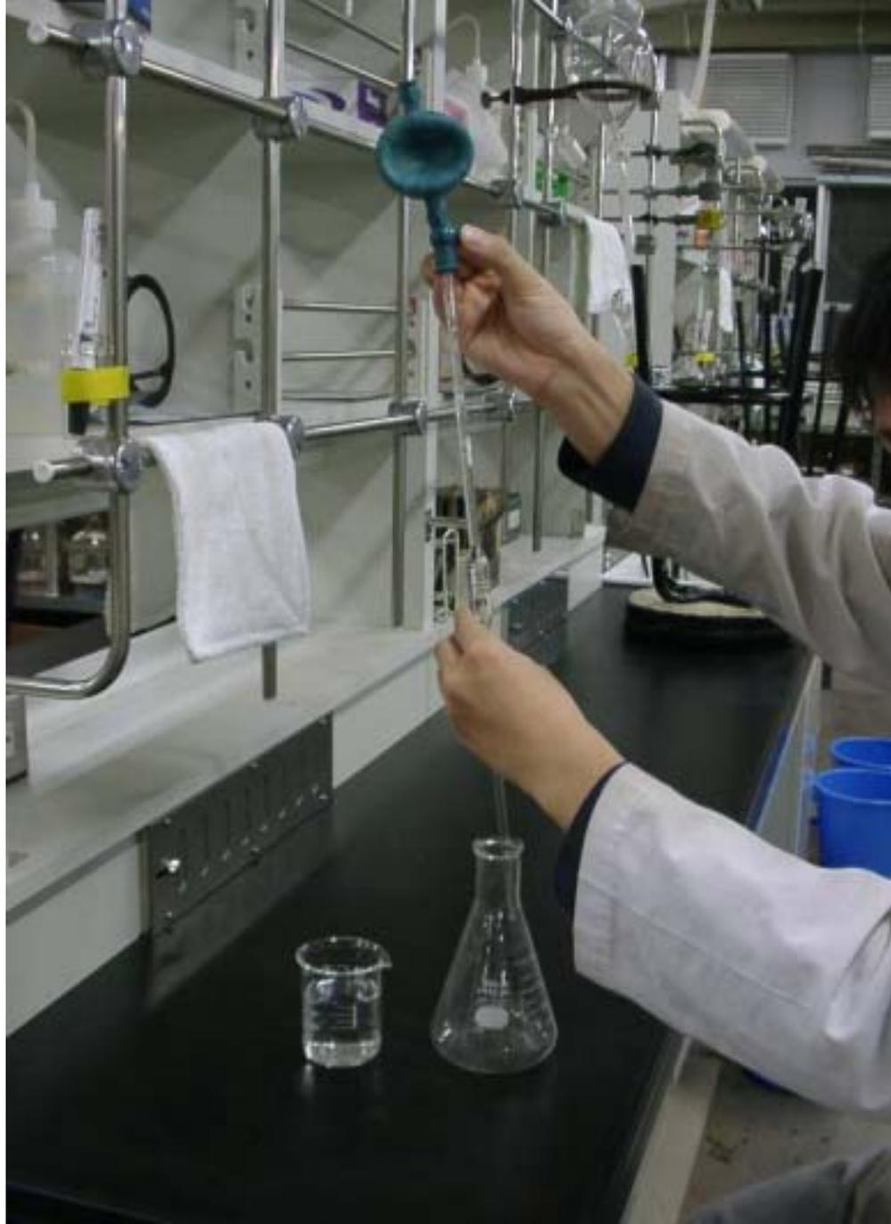
自由流出後、先端に残った溶液を出し切る。
