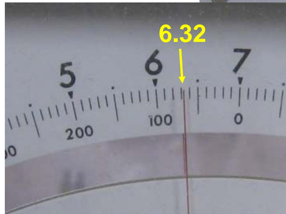
電位測定の精度  $\pm 1 \text{ mV}$
