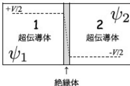
ジョセフソン素子は、上の図に示すように 2 nm 程度の薄い絶縁体を 2つの超伝導体ではさんだ構造をもつ(例えば Nb/Nb 酸化物/Nb)。絶縁体は 10 nm 程度の半導体や常伝導金属を用いてもよい。超伝導体は、化学の分野では NMR の超伝導マグネットにも使われているのでなじみであるが、抵抗ゼロで大電流が流せるものである。銅酸化物高温超伝導体フーバーのあと、最近では 150 GPa 高圧の金属水素化合物で常温に近い 280 K での超伝導が確認！された。
