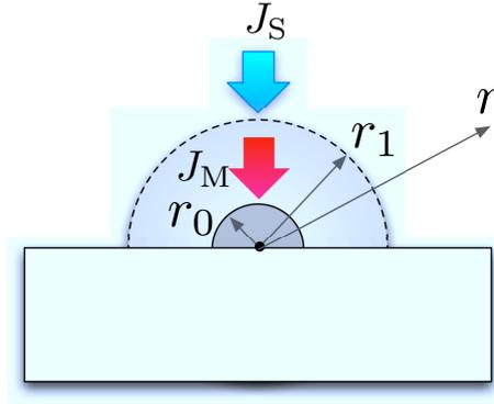
Figure 3: 半球型微小電極上での酵素センサー
