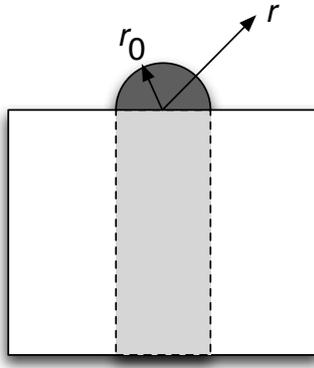
Figure 2: 半球型微小電極の例。数  $\mu\text{m}$  の白金線がガラスのなかに埋まっており、その先端部が微小電極 (UME) として作用する。
