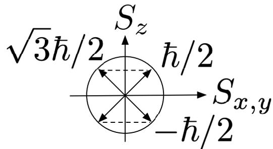
Figure 3: スピン角運動量の回転円錐軸への投影 それぞれの矢印の長さは,  $\sqrt{3}\hbar/2$  で, 円錐の高さは  $\pm\hbar/2$  である
