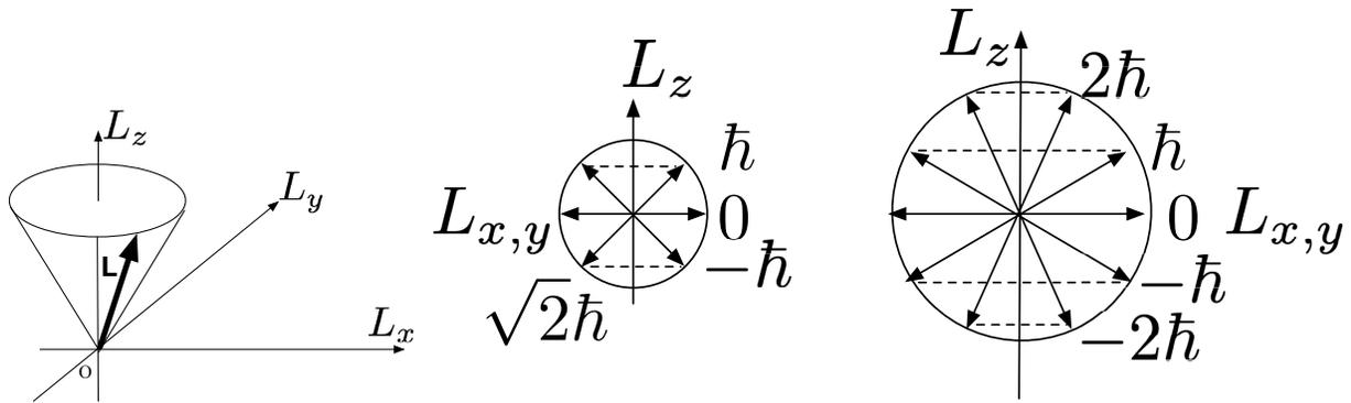
Figure 2:  $l = 1$  (左),  $l = 2$  (右) の円錐軸への投影 それぞれの矢印の長さは,  $\hbar\sqrt{l(l+1)}$  で, 円錐の高さは  $m\hbar$  である
